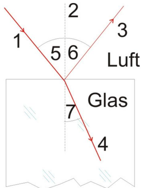
**55.** Der Einfallswinkel eines Lichtstrahls auf eine ebene Grenzfläche beträgt  $55^\circ$ . Wie groß ist der Winkel zwischen dem reflektierten und dem gebrochenen Strahl, wenn die Brechzahl  $n = 1,5$  ist?
