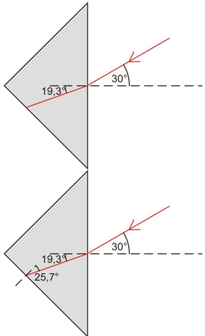
Das Licht verlässt unter einem Winkel von  $40,6^\circ$  das Prisma.
