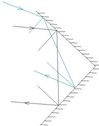
45. Wenn der Winkel zwischen Spiegel und reflektiertem Strahl  $40^\circ$  beträgt, ist der Reflexionswinkel der Ergänzungswinkel zu  $90^\circ$ , also  $50^\circ$ .
