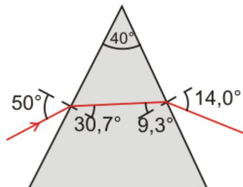
Nun ist aber nicht der Winkel gefragt, unter dem der Lichtstrahl das Glas verlässt, sondern der Winkel, unter dem der Strahl aus seiner ursprünglichen Richtung abgelenkt wurde.
