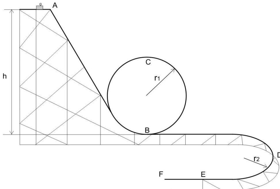
a) Im Punkt C muss aus Sicherheitsgründen die Geschwindigkeit **50% über der nötigen Mindestgeschwindigkeit** liegen. Zeigen Sie, dass dann die Gleichung
